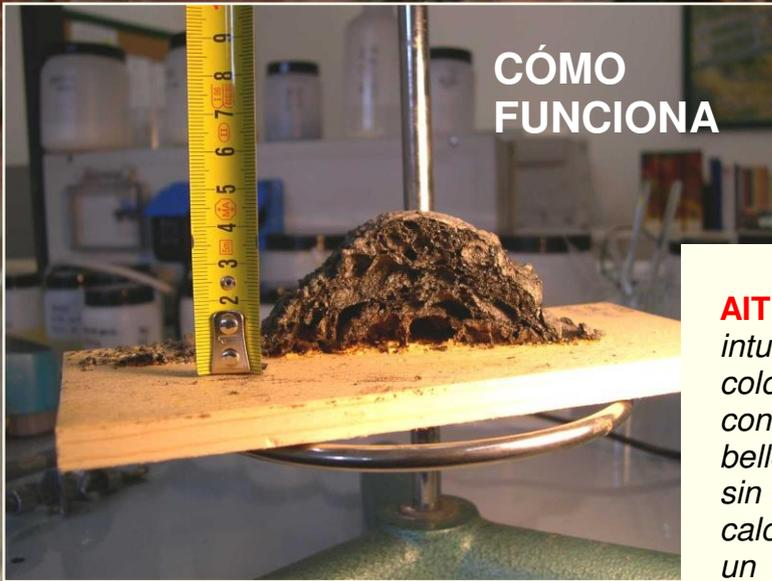
**AITHON PV 33** es un barniz intumescente, al agua y de color transparente. En condiciones normales realza la belleza natural de la madera, sin embargo, ante la acción del calor generado por el fuego de un incendio, se expande transformándose en una capa de “espuma” que actúa como escudo aislante a temperaturas superiores a los 1000°C retardando hasta 60 min el contacto entre la llama y la superficie de madera.
